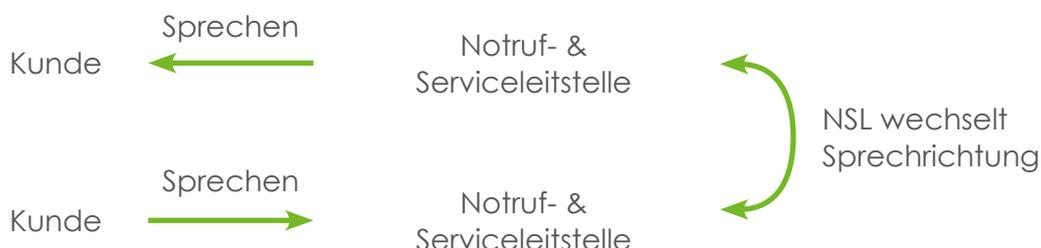
Abb. 9: Wechselsprech-Funktion
